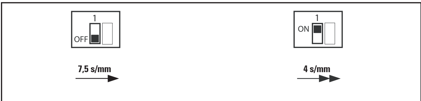
Abb. 6.8 - Einstellung der DIP-Schalter: Schalter S1.1
